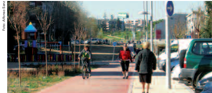
Fig. 4. La acera, insuficiente, en la posición en la que debería situarse la vía ciclista.
