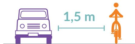
Figura 114. Indicación de espacio entre automóvil y bicicleta para vías de velocidad superior a 50 km/h
