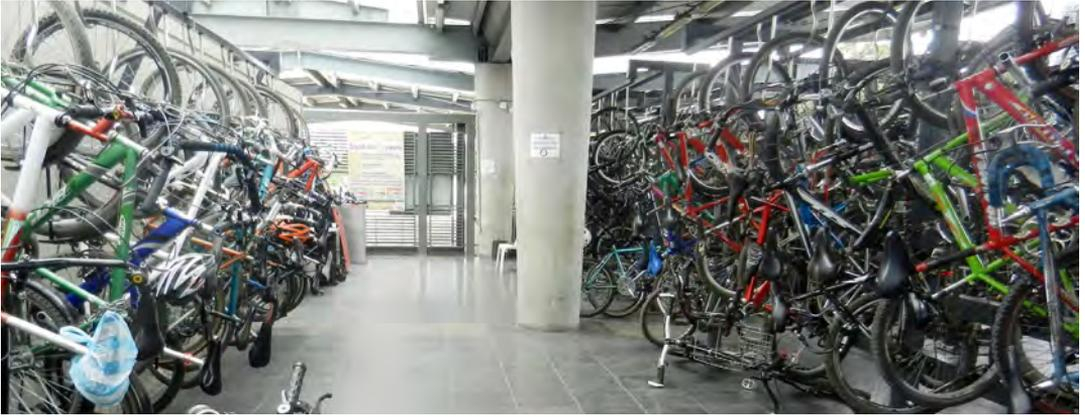
Foto 53. Estacionamiento para bicicletas de colocación vertical en el sistema Transmilenio de Bogotá
