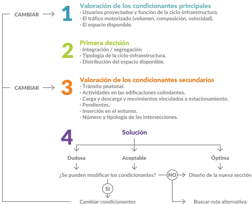
Figura 31. Metodología para diseñar una sección ciclo-inclusiva
