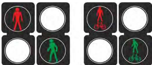
Figura 89. Señales semafóricas adaptadas a la circulación de bicicletas. Fuente: Manual de Señalización Vial de Colombia (2015)
