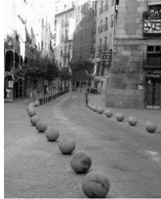
Su instalación masiva como único elemento de segregación entre calzadas y aceras produce un resultado excesivamente duro, por lo que conviene su alternancia con otros elementos de urbanización.
