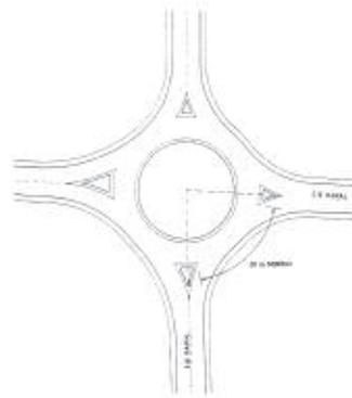
Fig. 10. Disposición de los ejes de los ramales y separación entre entradas
