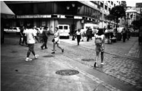
El eje peatonal pavimentado con losas de piedra es atravesado por una banda de rodadura en adoquín de granito en el Centro Histórico de Salamanca. Proyecto del año 1996.
