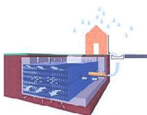
Bloque de filtración y esquema del sistema DRAIN-MAX
