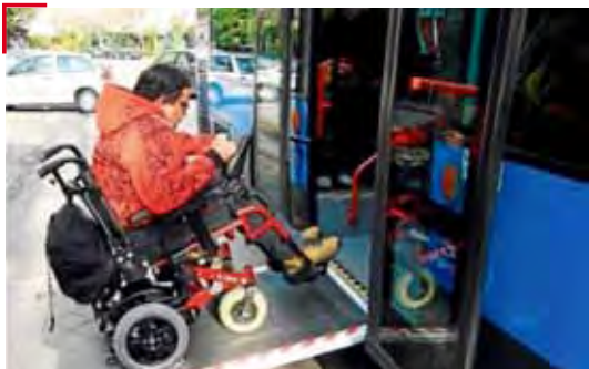
Fig.8: El autobús de piso bajo acompañado del sistema de inclinación lateral o "kneeling", permite acceder de forma autónoma a su interior.
