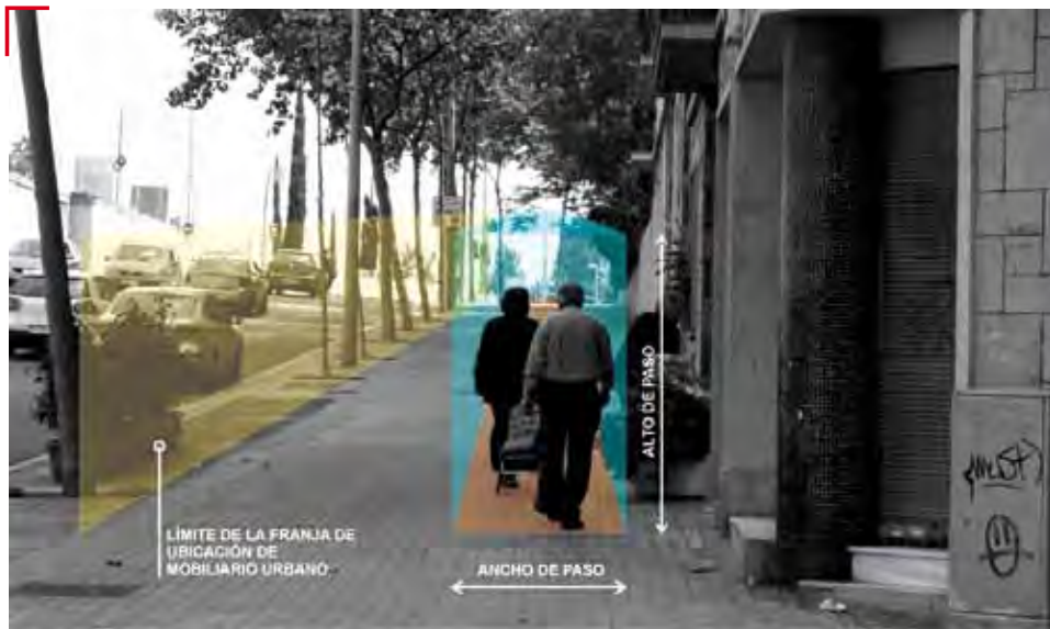
Fig.3: Tramo en el itinerario peatonal, ancho y alto de paso.
