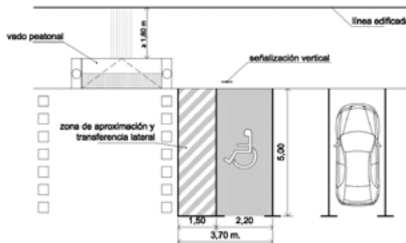
Figura 1: Plazas de aparcamiento reservadas dispuestas en perpendicular a la acera y con acceso compartido.
