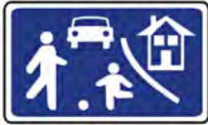
Fig.8: Señal S-28. Calle residencial.
