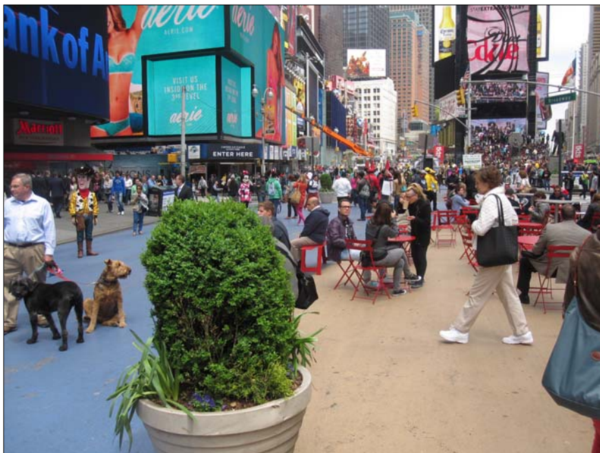
Times Square, NYC: transformación de la calzada donde en 2009 circulaban coches, únicamente a través de pintura y mobiliario urbano. Obsérvese a la izquierda el bordillo aún existente -porque no se ha realizado ninguna obra- que delimitaba el límite de la acera.
